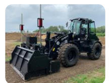
PlanFix 2 Planiermaschine, mit patentierter, hydr. Materialabgabefunktion.
